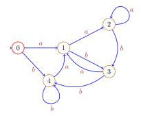
$\begin{array}{ll} \delta(2,a) = 2 & w_2.a = a.aa \\ \delta(2,b) = 3 & w_2.b = a.ab \\ \delta(3,a) = 1 & w_3.a = ab.a \\ \delta(3,b) = 4 & w_3.b = ab.b \end{array}$
