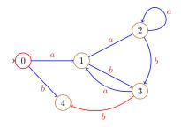
$$\begin{split} &\delta(2,a) = 2 \quad w_2.a = a.aa \\ &\delta(2,b) = 3 \quad w_2.b = a.ab \\ &\delta(3,a) = 1 \quad w_3.a = ab.a \\ &\delta(3,b) = 4 \quad w_3.b = ab.b \end{split}$$
