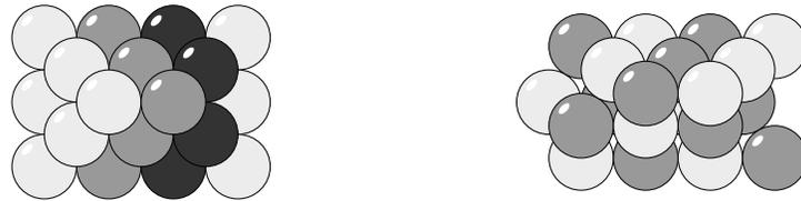
FIGURE 4 – L’empilement par couches carrées est un cas particulier d’empilement par couches hexagonales compactes. La coloration suit les couches hexagonales compactes à gauche et les couches carrées à droite.
