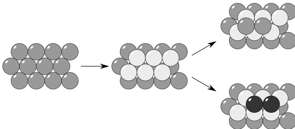
FIGURE 3 – Empiler des oranges par couches hexagonales compactes.
