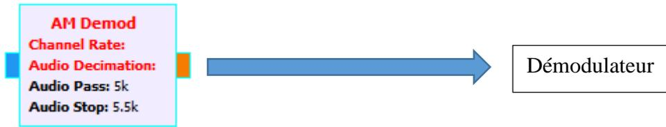
L'un des blocs essentiels de notre projet. Celui-là nous permet de démoduler comme son nom l'indique les signaux modulés en amplitude. Nous pouvons aussi démoduler des signaux QAM, FM, OFDM, PSK etc.
