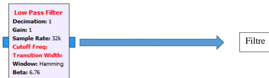
Ici, nous utilisons un filtre passe-bas sur lequel nous pouvons régler la fréquence de coupure, la vitesse à laquelle la pente descend lorsqu'elle atteint  $F_c$ , la fréquence d'échantillonnage etc.
