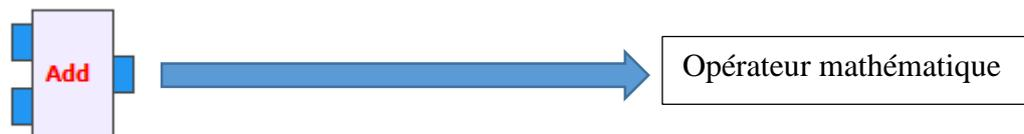
Ce bloc lui permet d'additionner plusieurs signaux (on peut additionner plus de 2 signaux en augmentant les entrées). Il existe aussi d'autres opérateurs mathématiques.
