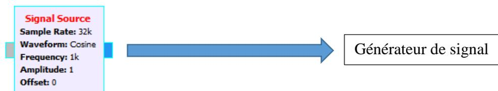
Ce bloc permet de générer un signal (sinus, cosinus, carré etc) et ses caractéristiques (fréquence, amplitude, offset).
